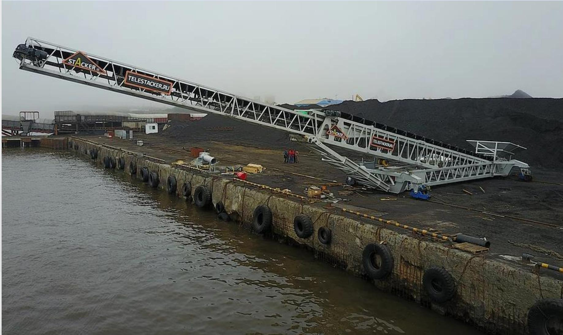
Судопогрузчик насыпных грузов Телестакер отечественного производства (ООО «Стакер»)
