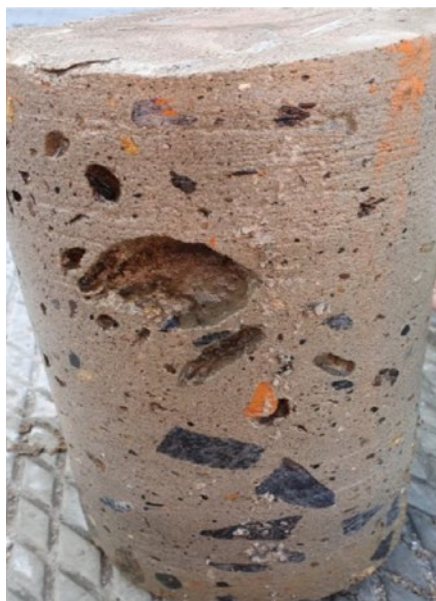
Рисунок 2. Речной грунт, укрепленный геоплимерным шлакощелочным вяжущим, набирает прочность до 20 Мпа при отрицательных температурах в арктической зоне (р. Северная Двина близ Инты) [21]
